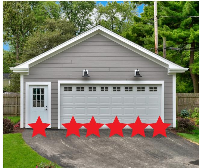
*Sacos de areia devem ser usados em qualquer entrada de sua casa, incluindo portas e garagens (conforme indicado pelas estrelas vermelhas). Os sacos devem ser colocados paralelamente à direção do fluxo de água.*
